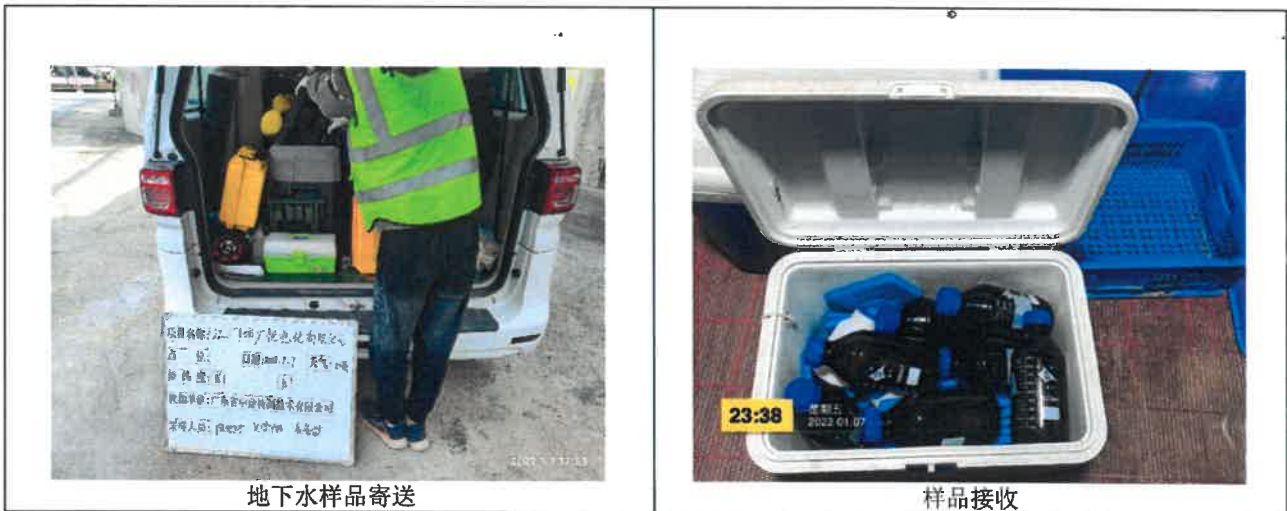
图 2.7-4 地下水样品保存与流转照片
